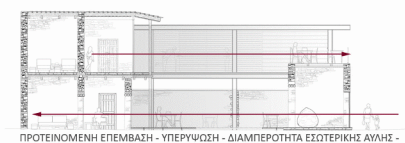
ΠΡΟΤΙΝΟΜΕΝΗ ΕΠΕΜΒΑΣΗ - ΥΠΕΡΥΨΩΣΗ - ΔΙΑΜΠΕΡΟΤΗΤΑ ΕΣΩΤΕΡΙΚΗΣ ΑΥΛΗΣ - ΕΝΙΣΧΥΣΗ ΚΙΝΗΣΕΩΣ ΚΑΙ ΣΤΑ ΔΥΟ ΕΠΙΠΕΔΑ
